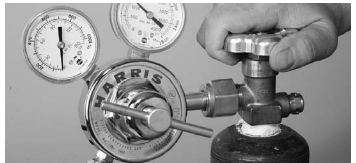
Figure 10. Ouverture du robinet d'oxygène
