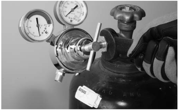
Figura 3. Acoplamiento del regulador de gas combustible
