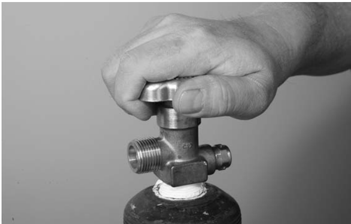
Figura 1. Apertura de la válvula de oxígeno del cilindro
