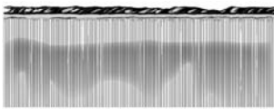
D. Demasiado precalentamiento, borde superior redondeado. Demasiado precalentamiento no aumenta la velocidad de corte. Sólo desperdicia gas.
