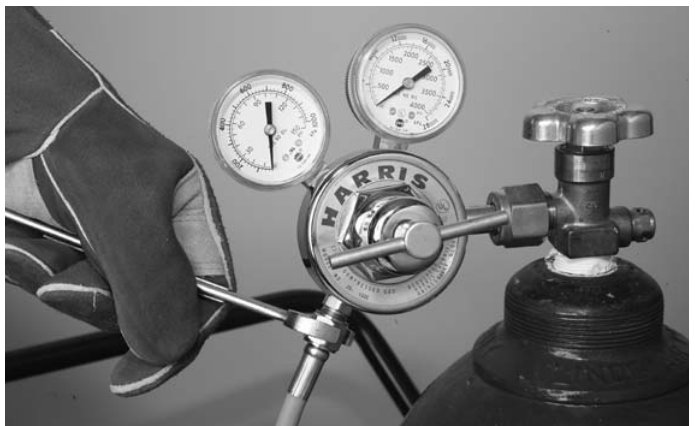
Figure 4. Raccordement du flexible au détendeur
