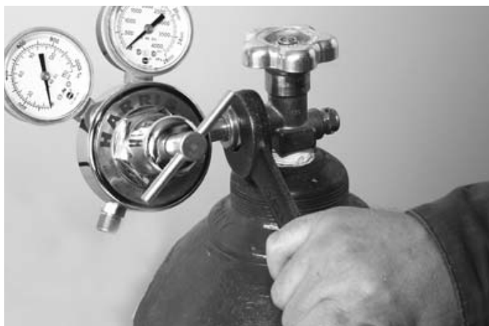
Figure 2. Raccordement du détendeur de l'oxygène
