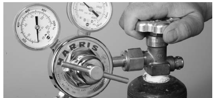
Figura 10. Apertura de la válvula de oxígeno
