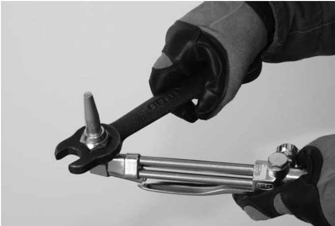
Figure 7. Montage du bec de découpage
