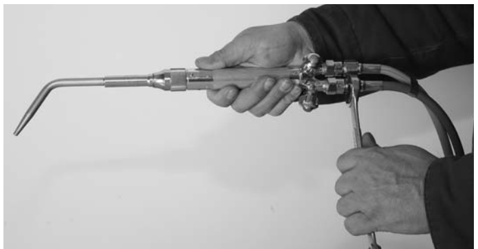
Figure 5. Raccordement du flexible au chalumeau
