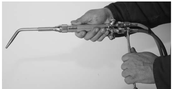
Figura 5. Acoplamiento de la manguera al soplete
