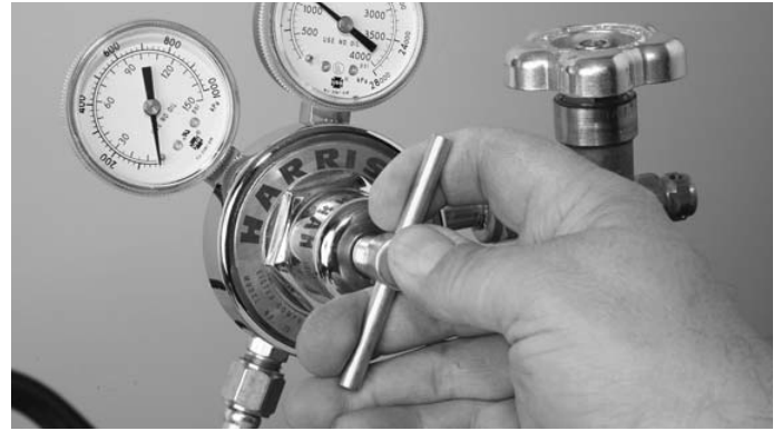
Figure 8. Clé de réglage du détendeur
