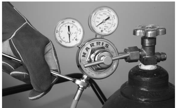
Figura 4. Acoplamiento de la manguera al regulador
