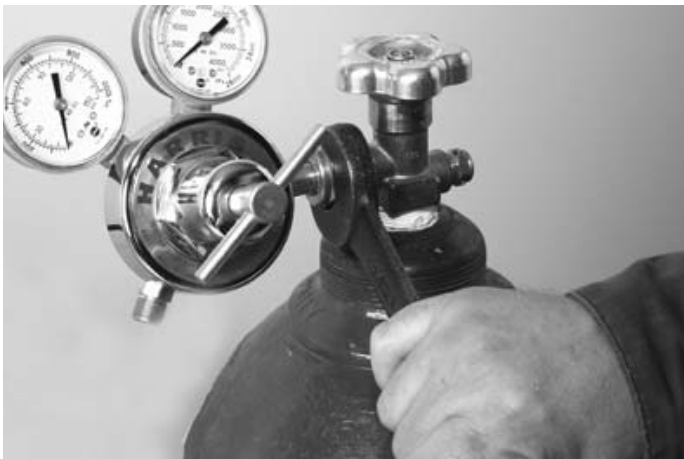
Figura 2. Acoplamiento del regulador de oxígeno
