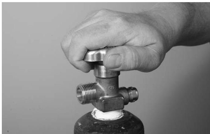
Figure 1. Ouverture du robinet de la bouteille d'oxygène
