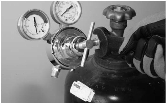
Figure 3. Raccordement du détendeur du gaz combustible
