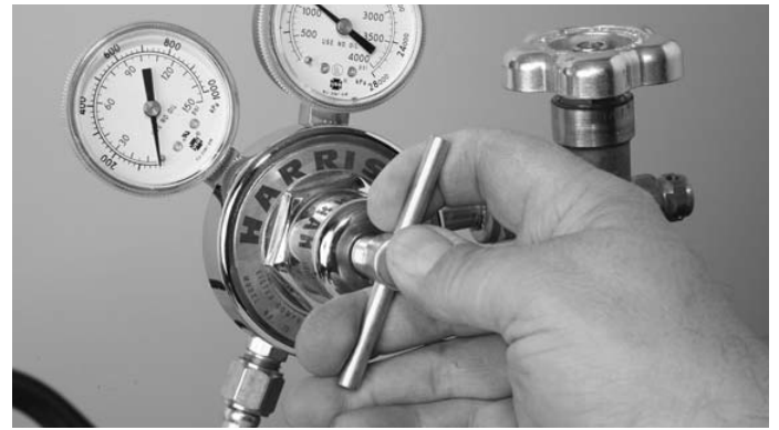
Figura 8. Llave de ajuste del regulador
